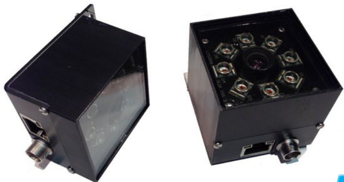
Integriertes GR2 Lesemodul mit GigE Standard. Hohe Auflösung und integrierte LED-Beleuchtung in Kompaktgehäuse mit 50 x 50 x 47mm,
